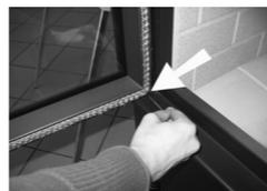
3. Faites pivoter la porte. Serrez ensuite la vis à 6 pans creux sur la charnière inférieure à l'aide d'une clé hexagonale 3 mm.
